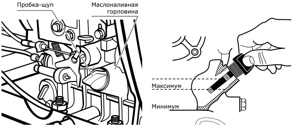
Рис. 9. Заполнение масляного картера и контроль уровня масла
