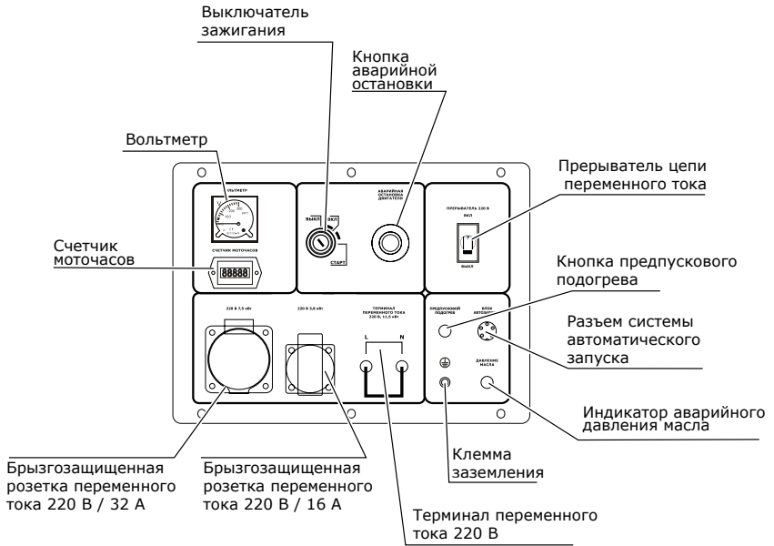
Рис. 5. Схема панели управления генераторов УГД-11500Е и УГД-15000Е
