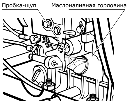
Рис. 2 Заполнение масляного картера
